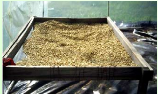
Interior del secador, piso de plástico negro, café en cajillas
